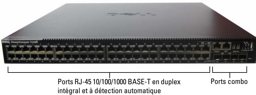
Figure 1-6. PowerConnect 7048R avec 48 ports 10/100/1000 BASE-T
