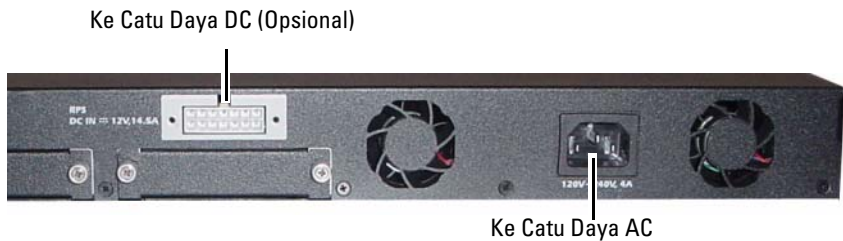
Gambar 1-15. Hubungan Daya AC dan DC ke Switch
